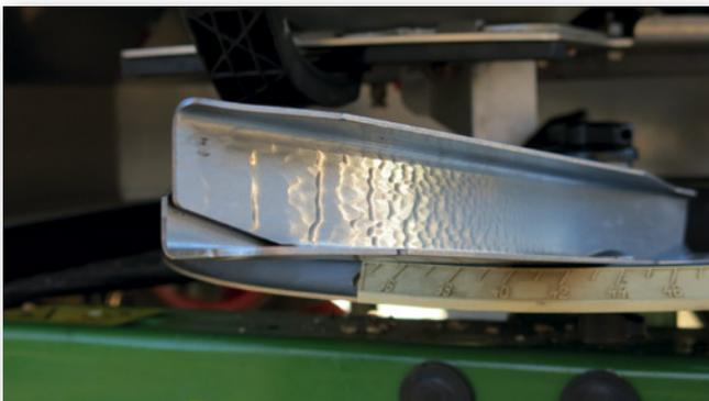
*Abbildung 20: Verschlossene Streuschaufeln (Quelle: Lossie)*
