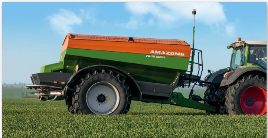
Abbildung 12: Gezogener Düngerstreuer, ausgerüstet mit Windmesser (vorne) und Streubildkontrolle (hinten) zum Ausgleich von Seitenwind (Quelle: Werkbild Amazone)
