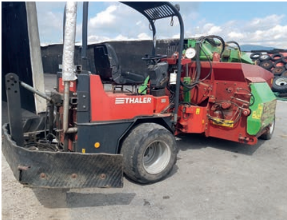
links: Am Heck dieses Selbstfahrer-Reißkamms ist ein hydraulisch verstellbares Schiebeschild „Marke Eigenbau“ zum Futteranschieben und Trogleerräumen angebaut.
