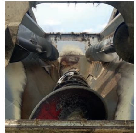
rechts: Innenraum eines Schneckenmischers mit der großen Hauptschnecke unten und den gegenläufigen Mischschnecken oben.
